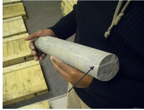
(d) Calcite vein filling a vertical fracture
