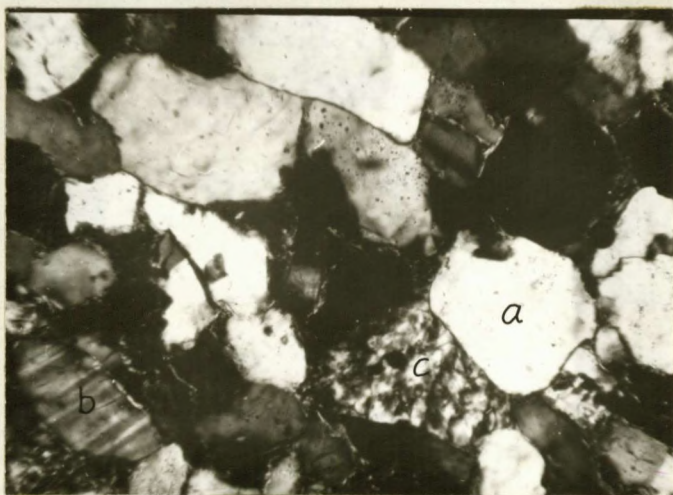
B. Mineralogiese samestelling van die kruisgelaagde sandsteen. a-kwarts, b-veldspaat, c-metamorfe kwartskorrel. (X110, X nicols.)
