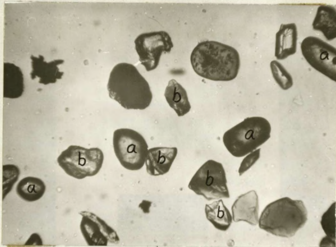
B. Goed afgeronde sirkoonkorrels (a) en hoekige granaatkorrels (b) in 'n swaarmineraalkonsentraat van 'n kruisgelaagde sandsteen. (XII0.)
