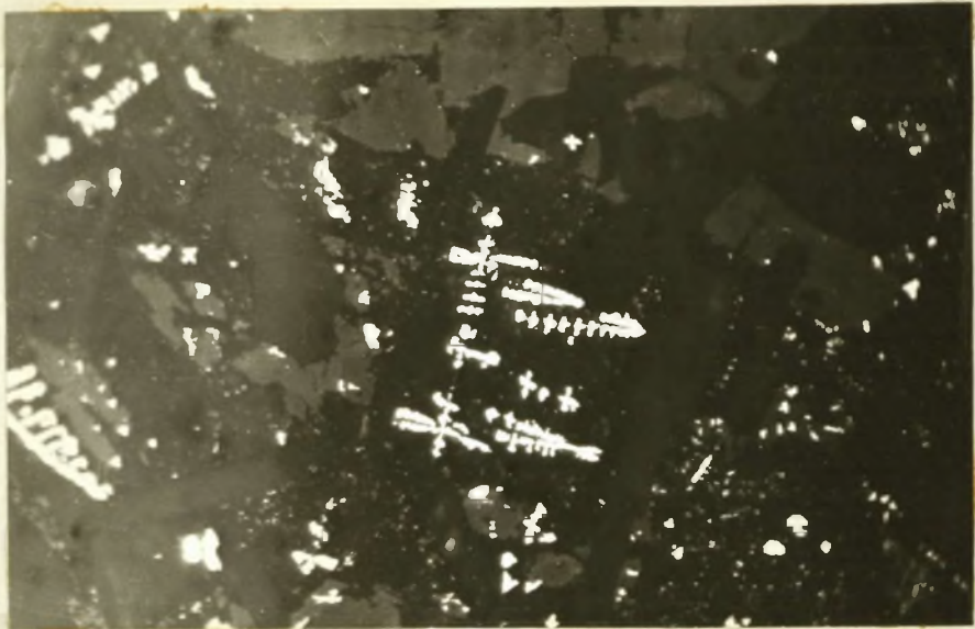
(b) Skeletkristalle van magnetiet in pirokseen (Vergroting 200X) (gekruisde nicols)
