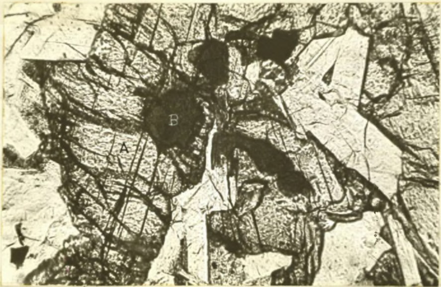
(a) Verandering van pirokseen (A) na chloritiese materiaal (B) (Vergroting 80X) (parallel nicols)
