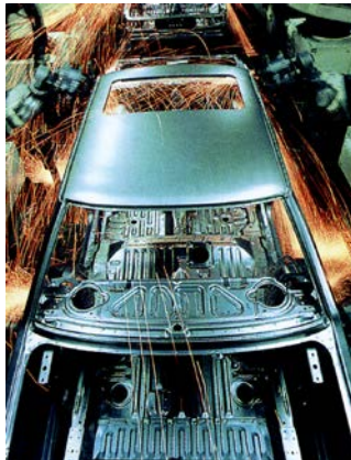
Figuur 8.13: 'n Motorbakwerk as 'n dopstruktuur
