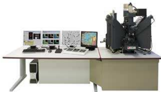
Fig. 2.2: CAMECA SX 100 Universal EMPA; www.cameca.fr
