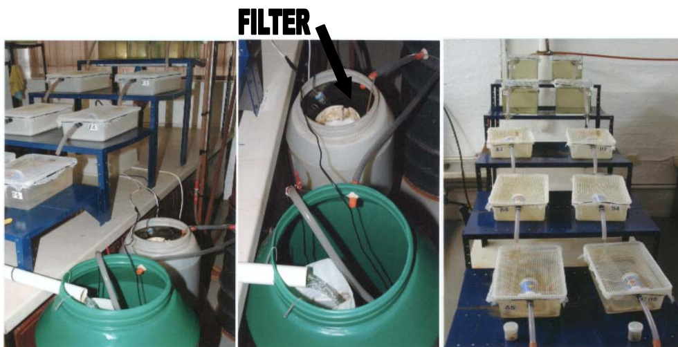
Foto 2. Die drom waarin die hele sisteem se water in saamloop, vanwaar dit na die filter gepomp word.
